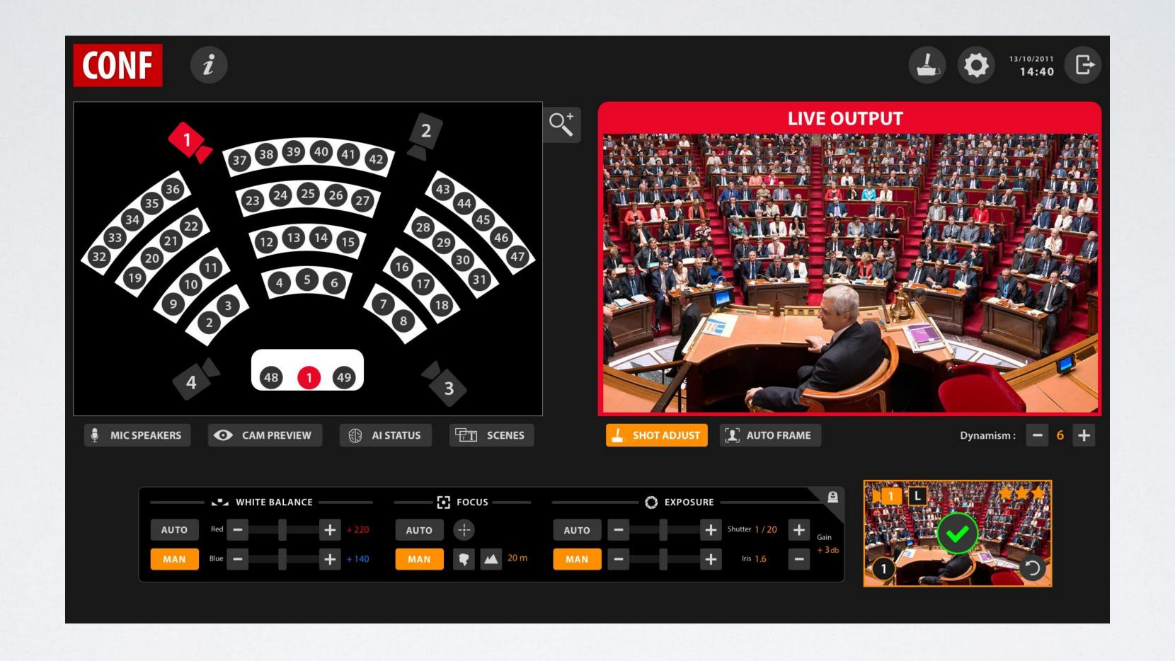
Chaque microphone est couvert par différents angles de prise de vue avec les caméras robotisées installées dans la salle de conférence.
